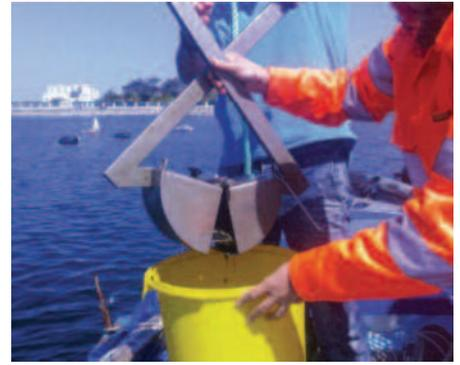
Monitoraggio Ambientale. Particolare della benna Van Veen utilizzata per il prelievo *in situ* dei sedimenti
